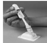
10. උපකරණයේ පැතලි කොටස තලයේ සතුලේ ගැටෙන සේ උපකරණය සම්පූර්ණයෙන්ම තලය තුලට ඇතුළු කරන්න. එතැන් සිට විනාඩි 20 ක් පරීක්ෂණ උපකරණය තලය තුළ තබන්න
